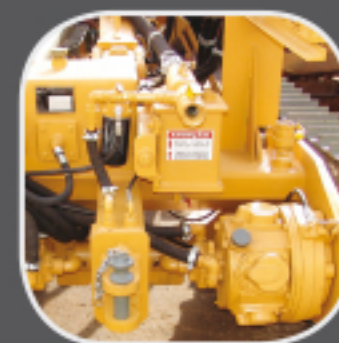
Sistema de injeção de água W-6674
